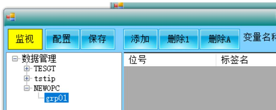
在上图中 “grp01”节点上 右键单击，选择 “参数设置”，可以设置该变量组的刷新频率，勾选激活复选框（否则变量不会刷新），如下图
